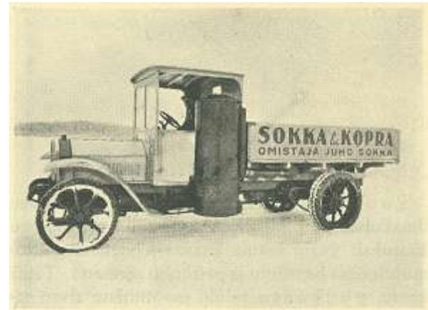
Viipurilaisen Sokka & Kopra Oy:n kuorma-auto varustettuna puukaasuttajalla v. 1928.
